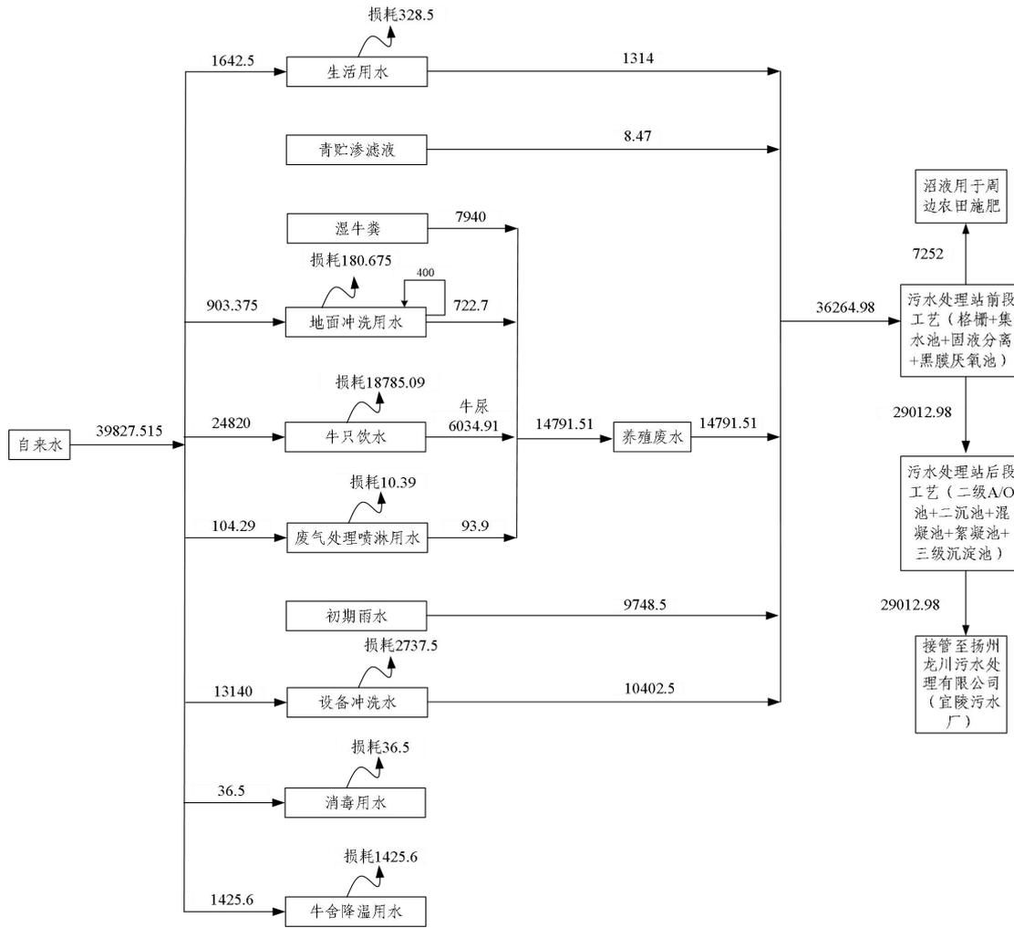
图 3.4-2 项目用水情况平衡图 (m³/a)
