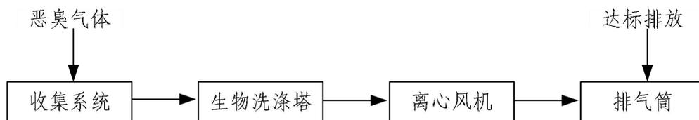
图 6.1-1 除臭设施工艺流程图
