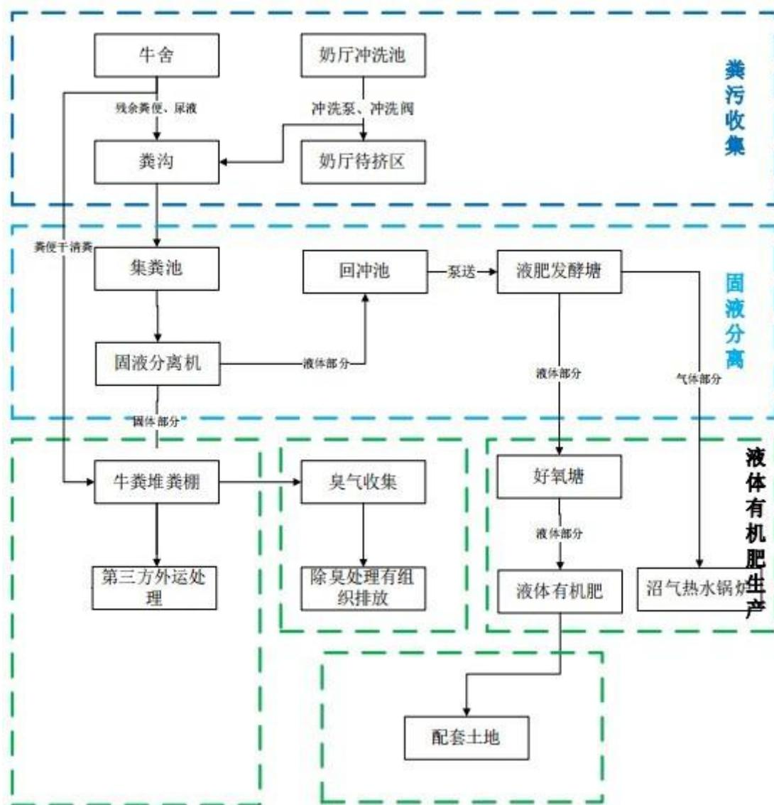
图 3.4-1 拟建项目粪肥处理工艺流程图
