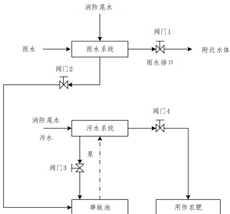
图 6.7-1 事故废水防范和处理流程示意图
