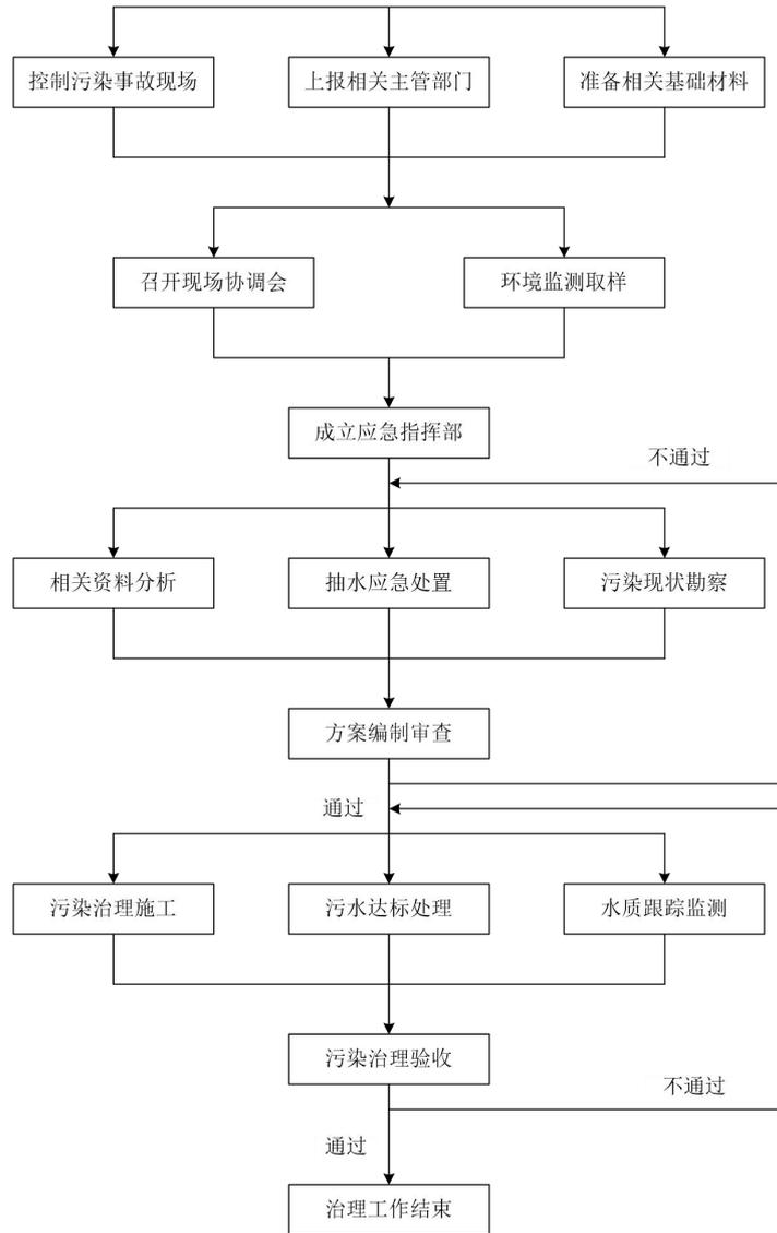
图 6.6-2 地下水污染应急治理程序图
