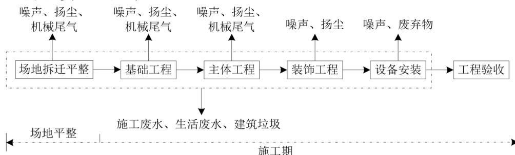
图 3.3-1 施工工艺流程及产污节点图
