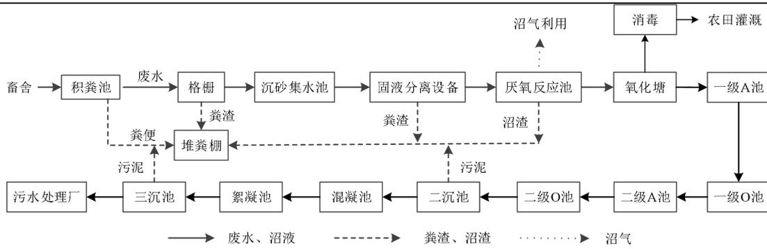
图 6.2-1 废水处理工艺流程图
