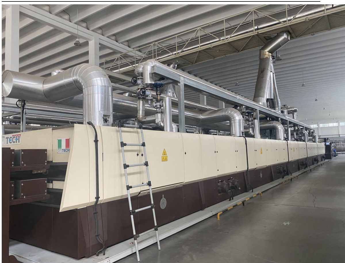
图 7.1.2-1 定型机照片（同类型企业）
